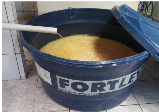
Figura 5: Fermentação da manipueira em tanques de polietileno. Fonte: Campos, 2015.
