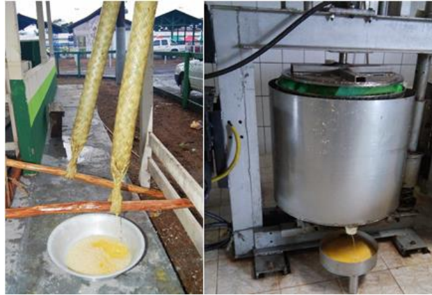
Figura 4: Prensa manual (tipiti) e prensa mecânica. Fonte: Campos, 2015.
